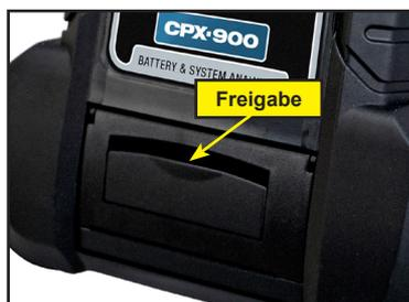
2. Heben Sie die Abdeckung des Druckers an und nehmen Sie die verbrauchte Rolle heraus.
