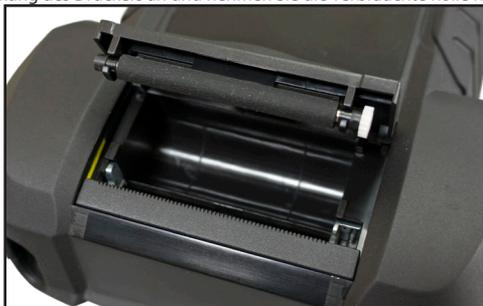
3. Legen Sie eine neue Papierrolle in das Fach ein. Das Papier wird von der Unterseite der Rolle abgewickelt.
